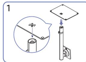
1 Stellen Sie den Standfuß in der in der Abbildung gezeigten Richtung auf den Standfußanschluss. Vergewissern Sie sich, dass der Standfußanschluss fest verbunden ist.
