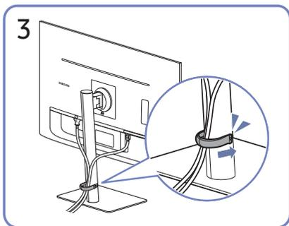
3 Verlegen Sie beide Kabel wie in der Abbildung gezeigt im Kabelhalter am Standfuß (STANDFUSSKABEL-HALTERUNG), um die Kabel zu organisieren.
