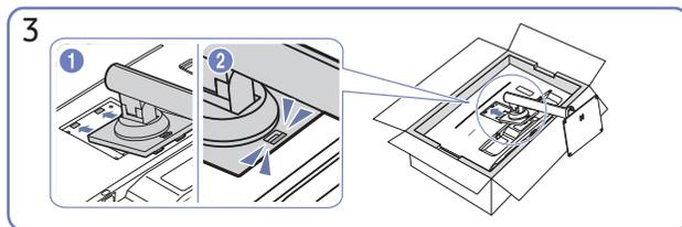
3 Schieben Sie den montierten Standfuß in Pfeilrichtung (siehe Abbildung) in das Gerätegehäuse hinein.
