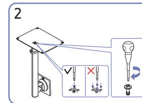
2 Drehen Sie die Befestigungsschraube unten am Standfuß bis zum Anschlag, damit er sicher befestigt ist. Ziehen Sie zur Montage die große Schraube in der Mitte an.
