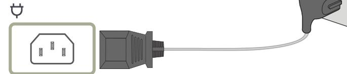
Um dieses Gerät zu verwenden, verbinden Sie das Netzkabel mit einer Steckdose und dem Anschluss des Geräts.
