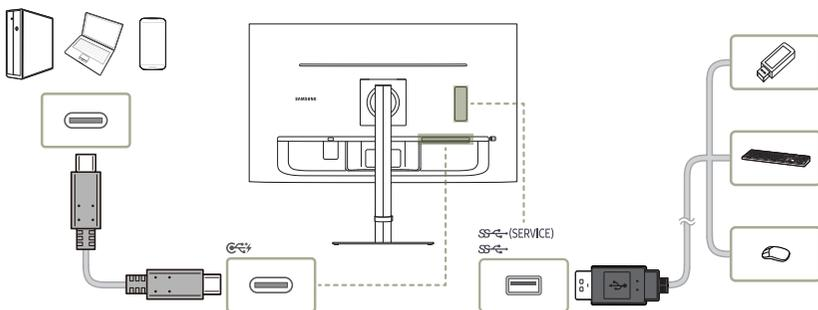
Wenn Sie das Gerät als Hub verwenden, können Sie jeweils verschiedene Quellgeräte mit dem Gerät verbinden und verwenden.
