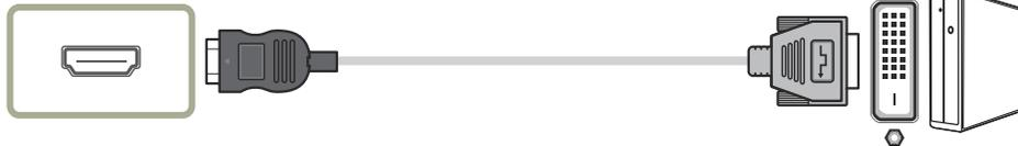
— Bei der Verwendung eines HDMI-DVI-Kabels wird je nach dem Quellgerät eventuell kein Audio unterstützt.
