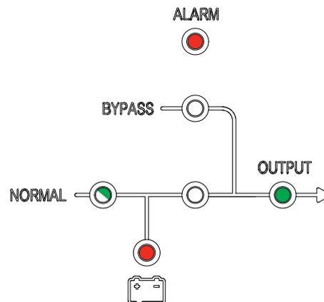
4. Wenn die Gleichrichter-LED stetig grün leuchtet, wechselt die USV in den statischen Bypass-Modus.
