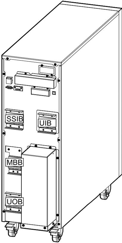
Rückansicht der 30-kVA-USV mit internen Batterien
