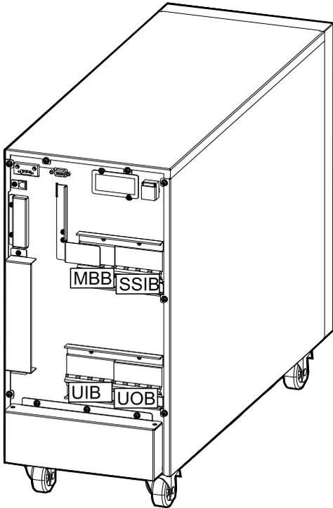
Rückansicht der 10–15-kVA-USV mit internen Batterien
