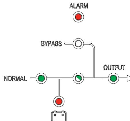
5. Wenn die Wechselrichter-LED stetig grün leuchtet, wechselt die USV automatisch aus dem statischen Bypass-Modus in den Normalbetrieb und wird in das laufende Parallelsystem aufgenommen.
