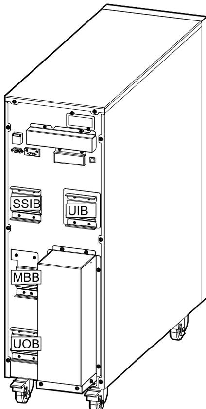
Rückansicht der 20-kVA-USV mit internen Batterien
