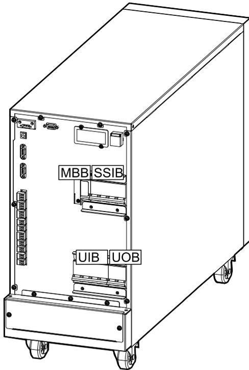
Rückansicht der 10–15-kVA-USV mit internen Batterien
