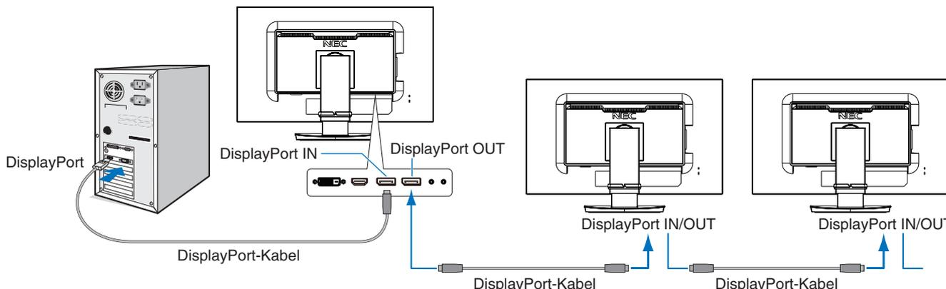
**HINWEIS:** Wenn auf dem Monitor kein Bild angezeigt wird, befolgen Sie die Fehlerbehebungsschritte im Abschnitt **Abhilfe bei fehlendem Bild**, und wählen Sie für DP VER. die Option 1.1 aus (siehe unten).
