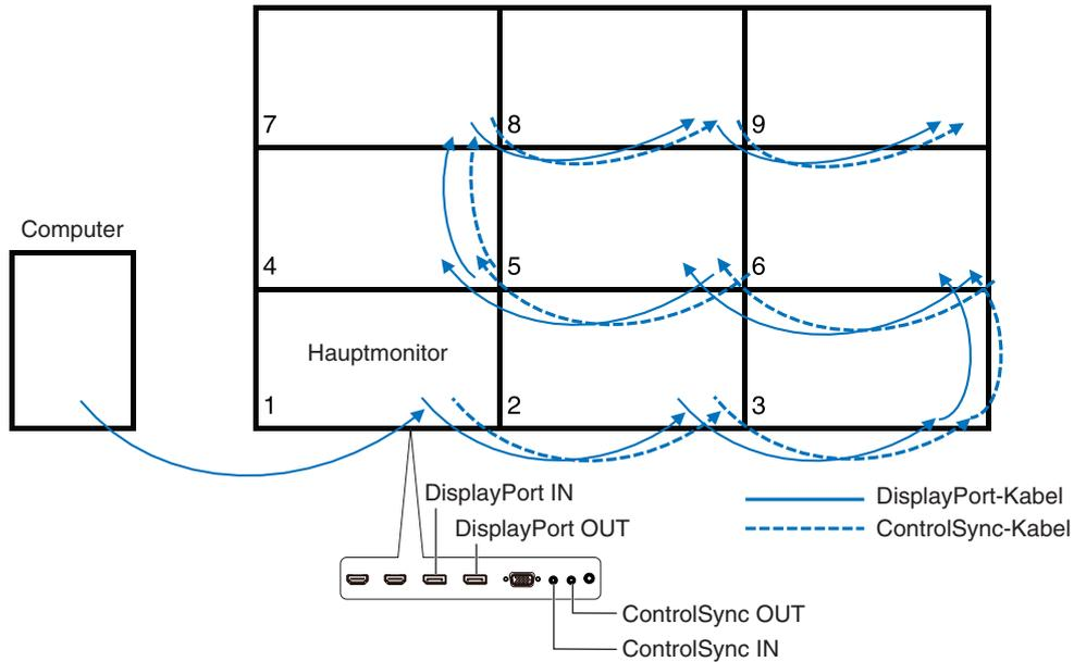
Wenn die Monitore mit ControlSync-Kabeln angeschlossen werden, müssen Sie sicherstellen, dass der an den Computer angeschlossene Computer der Hauptmonitor ist.
