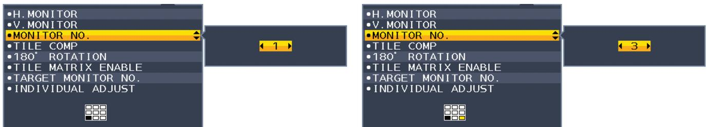
6. Versetzen Sie die Taste AB/AUF nach unten, um TILE MATRIX FREIG. auszuwählen, und legen Sie dann EIN fest. Nehmen Sie diese Einstellungen gemäß den oben genannten Schritten 1 bis 6 für jeden einzelnen Monitor vor.
