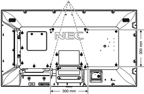
Montagezubehör kann an den Monitor angebracht werden, wenn dieser mit der Vorderseite nach unten liegt. Um Schaden an der Vorderseite zu verhindern, legen Sie die Schutzfolie auf den Tisch unter den LCD-Monitor. Der LCD-Monitor war zuvor in der Schutzfolie originalverpackt. Stellen Sie sicher, dass sich nichts auf dem Tisch befindet, was den Monitor beschädigen kann.
