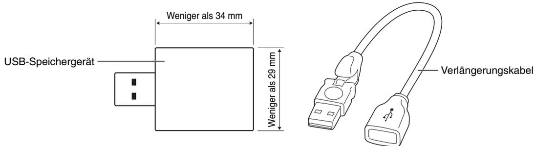
**HINWEIS:** Es kann nicht garantiert werden, dass dieser Monitor mit allen handelsüblichen USB-Speichergeräten funktioniert. Stellen Sie das USB-Speichergerät auf die Verwendung von USB MP ein (siehe Seite 18).
