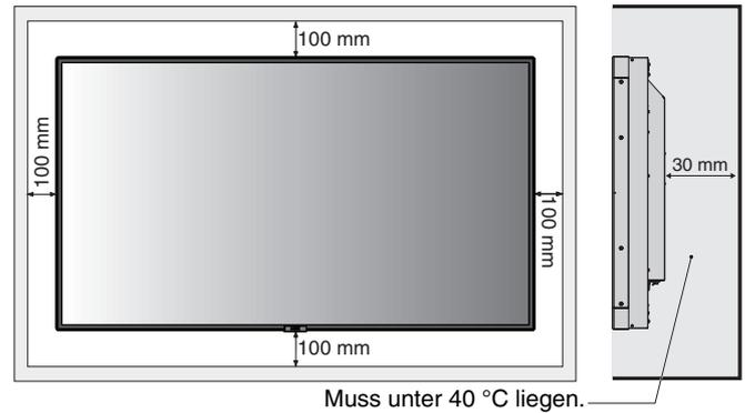
Achten Sie auf ausreichende Luftzufuhr oder sorgen Sie für Klimatisierung am Monitor und an der Halterung, damit die entstehende Wärme abgeführt werden kann, insbesondere, wenn Sie mehrere Monitore über- bzw. nebeneinander installieren.
