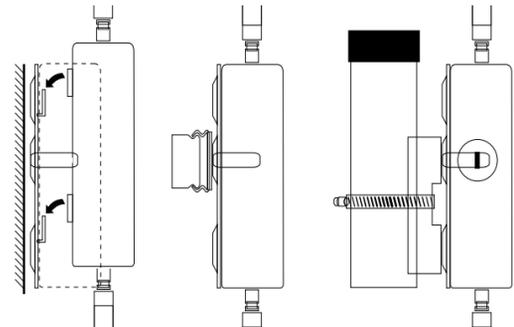
Rasten Sie das Gehäuse des Gerätes mit den vier rückseitigen Öffnungen in den Laschen der Grundplatte ein.
