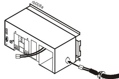
4 Die beiden Batterieanschlüsse fest zusammendrücken. Die Batterieanschlüsse im Batteriefach verstauen.
