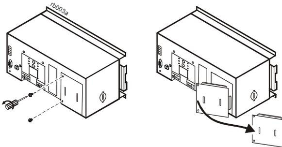
**2** Die Batterie aus dem Fach herausnehmen, um zu den Batterieanschlüssen zu gelangen. Die Batterie abklemmen.
