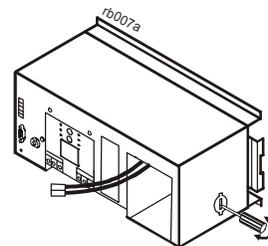
3 Das externe Batteriekabel und die im Lieferumfang der Batterie enthaltene Zugentlastung bereitlegen. Die Zugentlastung am externen Batteriekabel anklemmen. **ANMERKUNG: Nachdem die Zugentlastung am Kabel angeklemt wurde, kann sie weder geöffnet noch vom Kabel entfernt werden.** Das externe Batteriekabel durch die Öffnung in der USV schieben. Die Zugentlastung an der Öffnung in der USV festklemmen.
