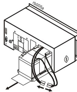
**3** Die Batterie ein Stück in die USV hineinschieben. Darauf achten, dass die Batterieanschlüsse außerhalb des USV-Gehäuses bleiben. Die beiden Batterieanschlüsse fest zusammendrücken. Die Batterie in die USV hineinschieben.
