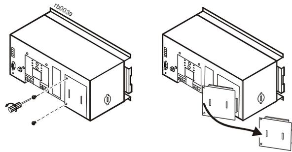
2 Die Ausdrückplatte entfernen, bei der sich die externe Batterie am besten einsetzen lässt. Zum Entfernen der Ausdrückplatte einen Schraubendreher verwenden.
