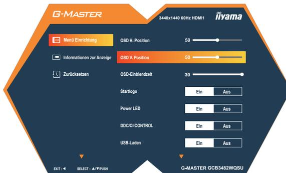
Drücken Sie auf den Joystick und kippen Sie ihn schließlich [↔], um die Funktion "On Screen Display" zu schließen. Alle Änderungen werden im Speicher abgelegt.
