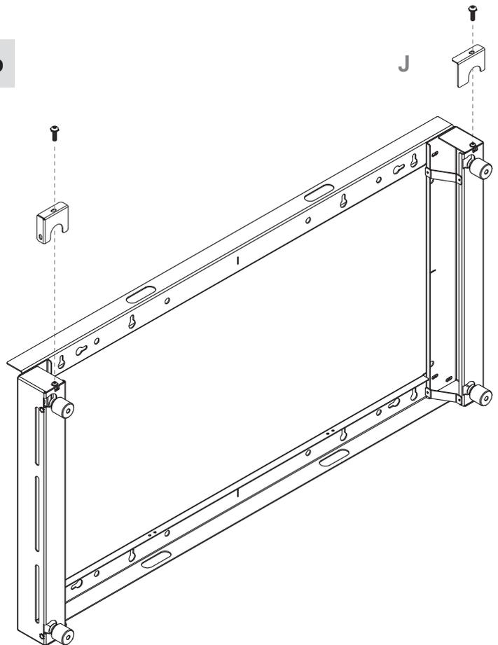
Lösen Sie die Sicherungsschrauben aus dem Rahmen und schieben Sie die Sicherungen über die Bolzen.
