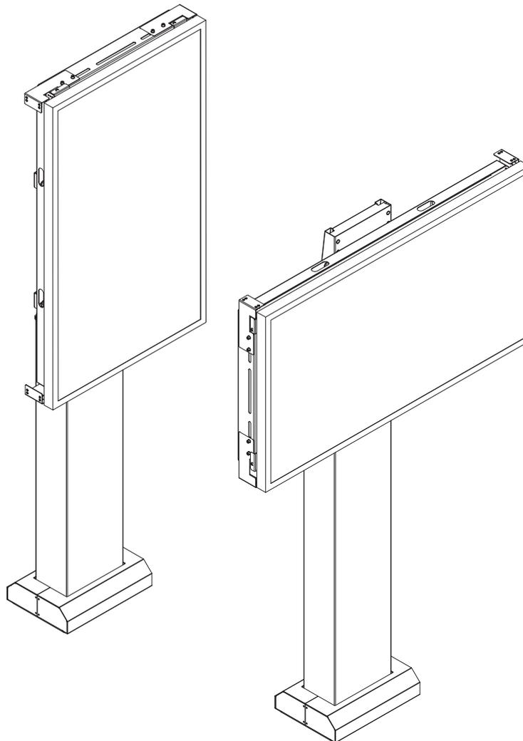
Schrauben Sie die Haltebolzen rückseitig in den Bildschirm. Hängen Sie den Bildschirm in die Schlüssellochbohrungen ein.
