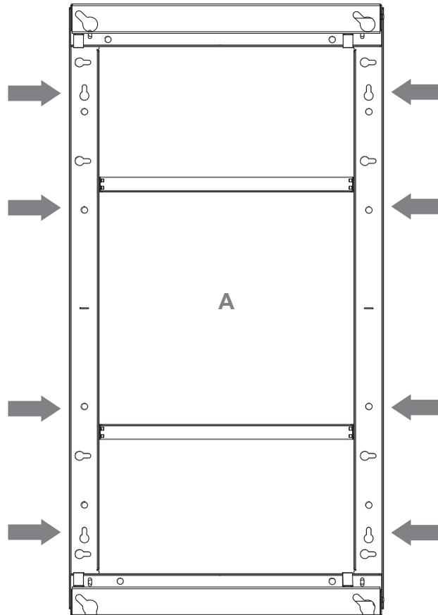
Markieren Sie die Bohrlöcher. Für eine exakte Ausrichtung empfehlen wir die Verwendung einer Laserwasserwaage. Bohren Sie die Löcher wie in der oberen Abbildung dargestellt.
