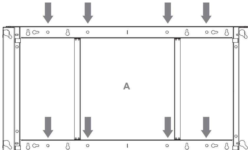
Markieren Sie die Bohrlöcher. Für eine exakte Ausrichtung empfehlen wir die Verwendung einer Laserwasserwaage. Bohren Sie die Löcher wie in der oberen Abbildung dargestellt. Die in der unteren Abbildung markierten Löcher können optional zusätzlich verwendet werden.
