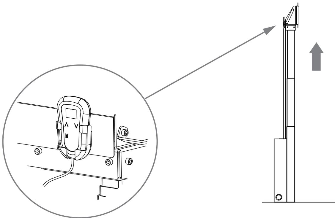
Schalten Sie das System ein und fahren Sie es mit Hilfe der Tastbedienung in die oberste Position.
