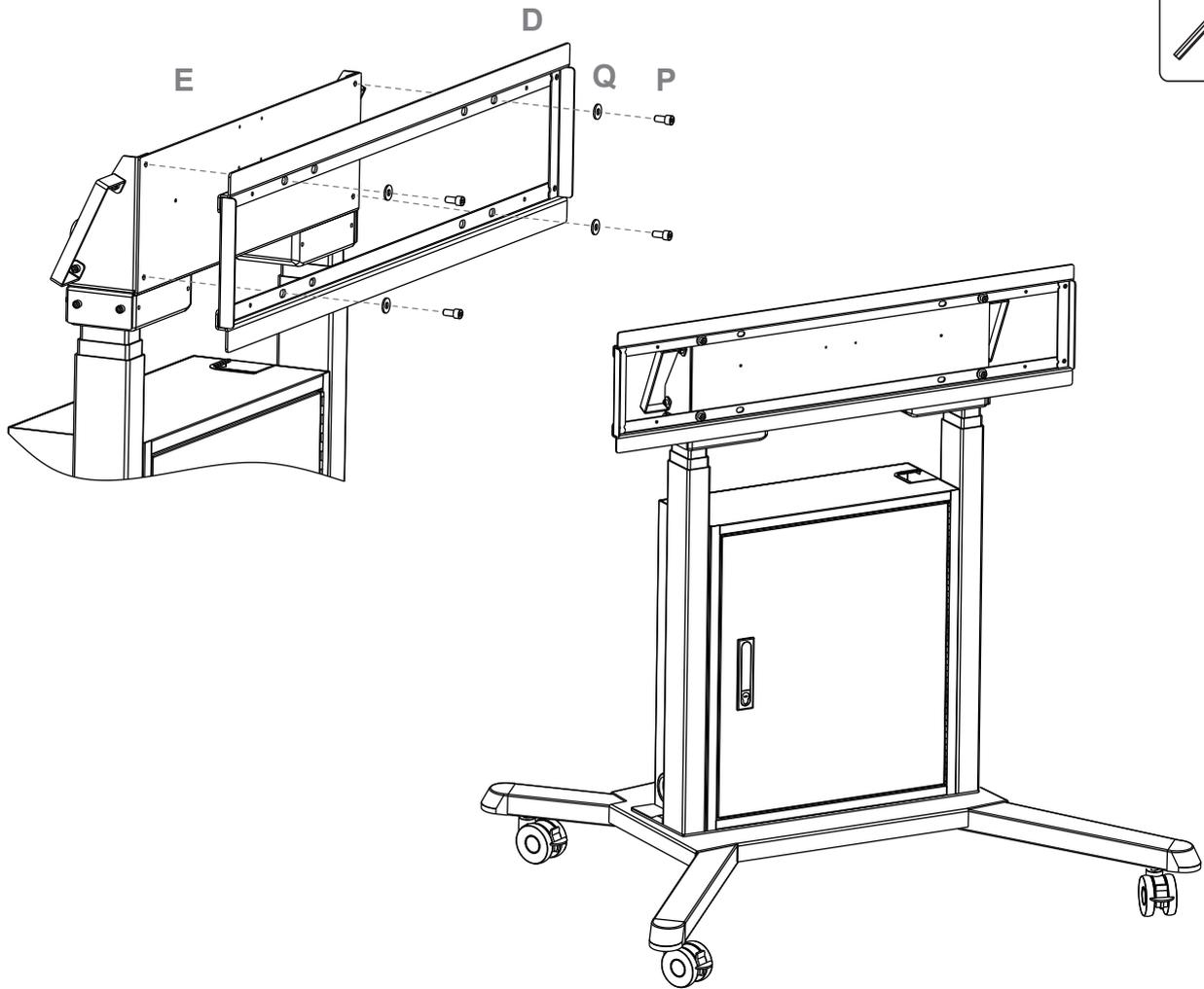
Verschrauben Sie die TV-Halterung an dem Kopf des Liftsystems. | Screw the TV bracket to the head of the lift system.
