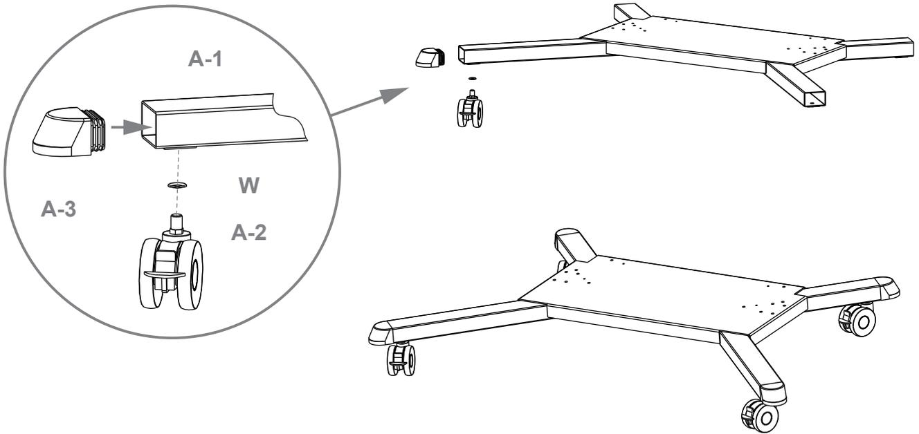
Montieren Sie die Rollen wie auf der Abbildung zu sehen. | Assemble the castors as shown in the picture.
