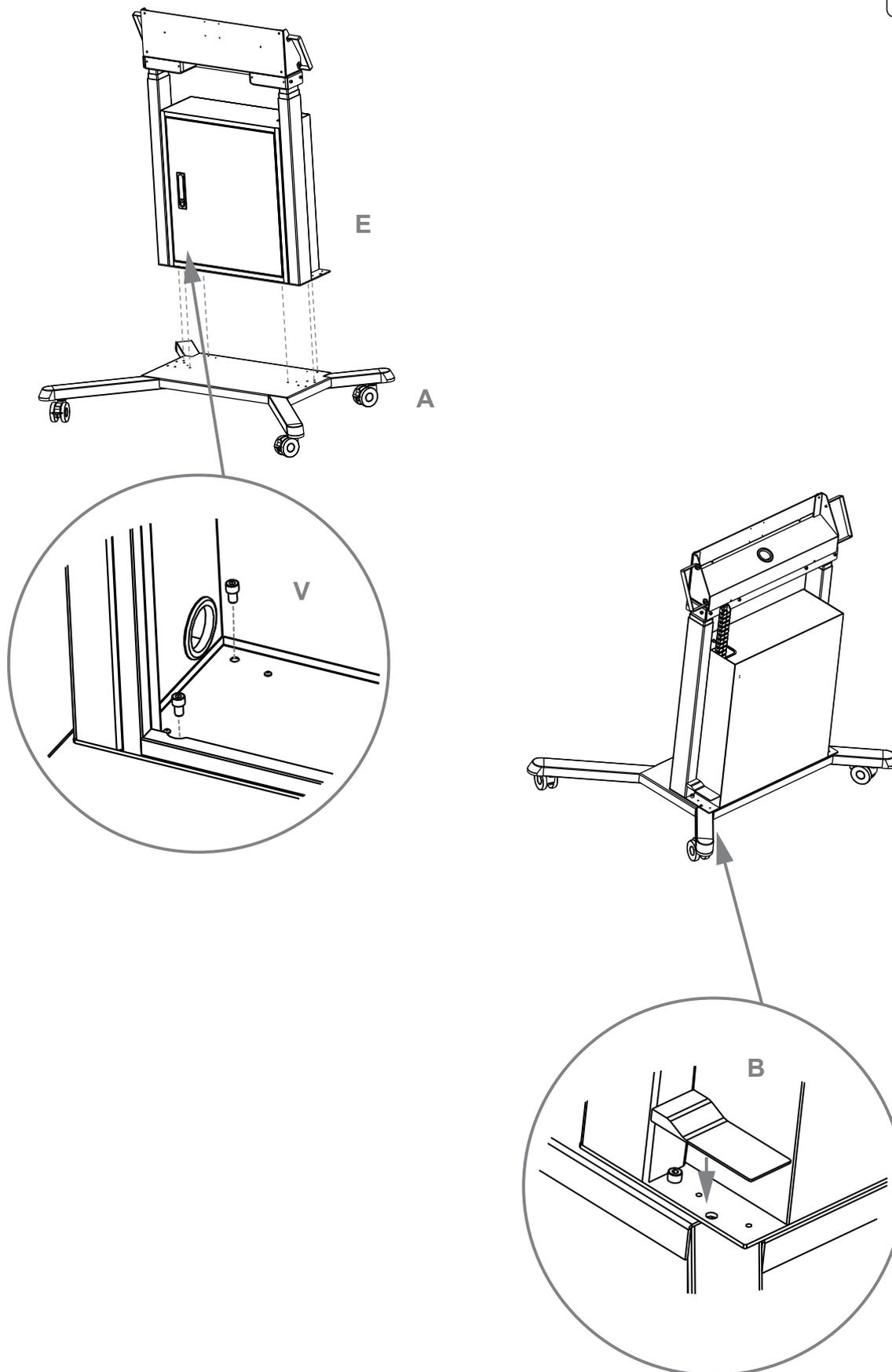
Verschrauben Sie das Liftsystem mit der mobilen Bodenplatte und setzen Sie die Abdeckung auf.
