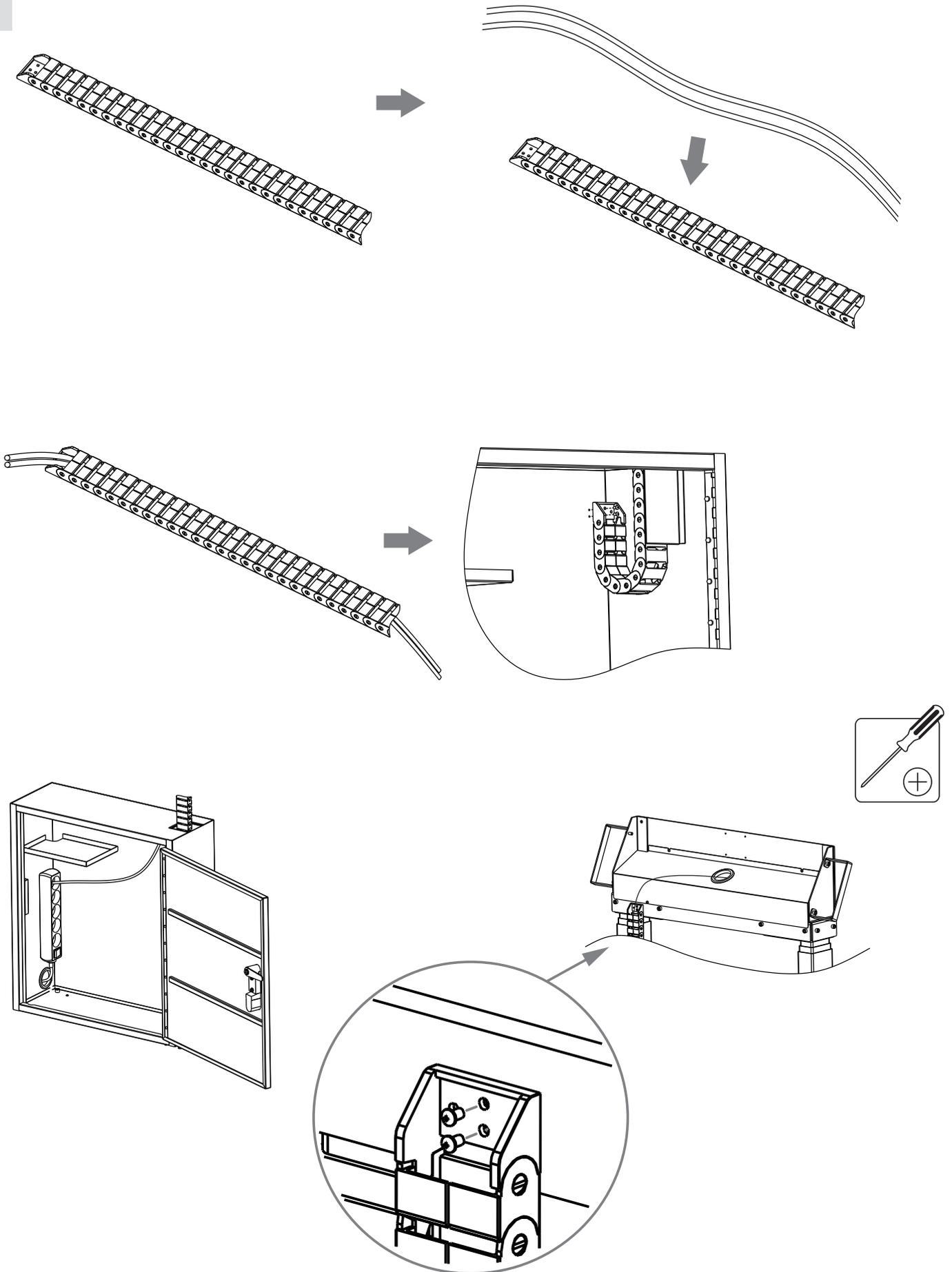
Legen Sie nun alle nötigen Kabel durch die Energieführungskette und schrauben Sie die Enden fest.
