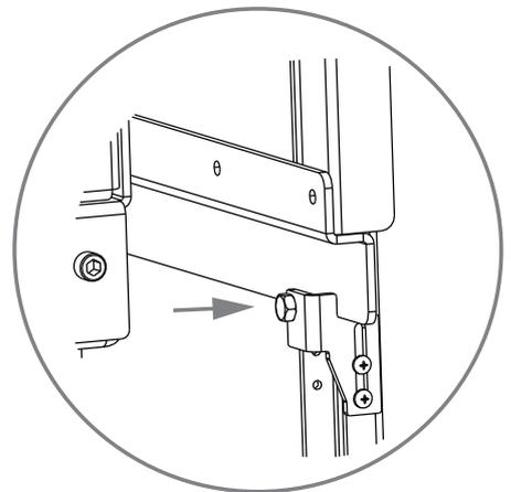
Schieben Sie die Sicherung zurück nach oben und schrauben Sie sie wieder fest.
