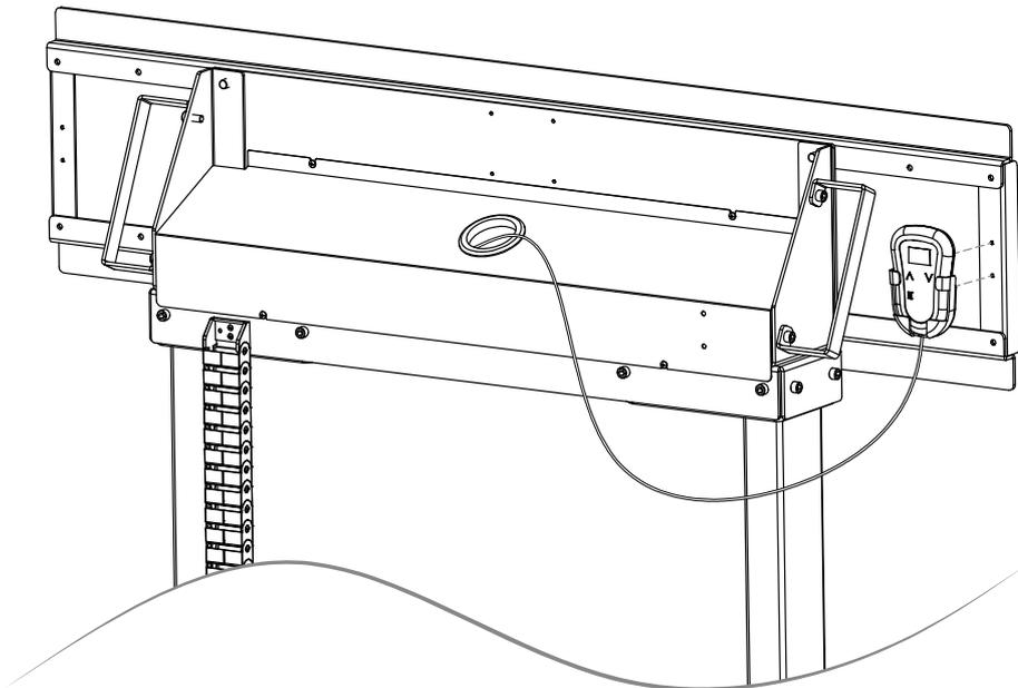
Verschrauben Sie die Tastbedienung rückseitig an der Halterung. | Screw the wired remote control to the back of the holder.
